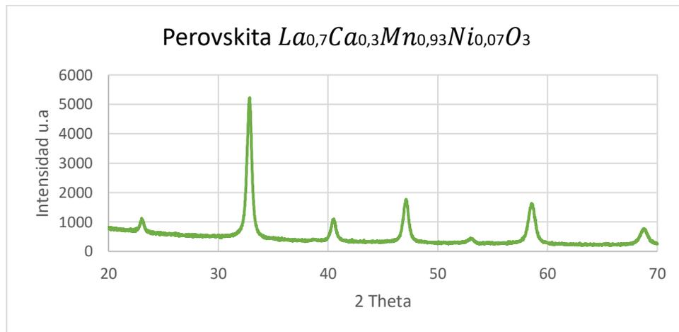
**Figura 15.** Patrón de difracción perovskita  $La_{0,7}Ca_{0,3}Mn_{0,9}Ni_{0,1}O_3$
