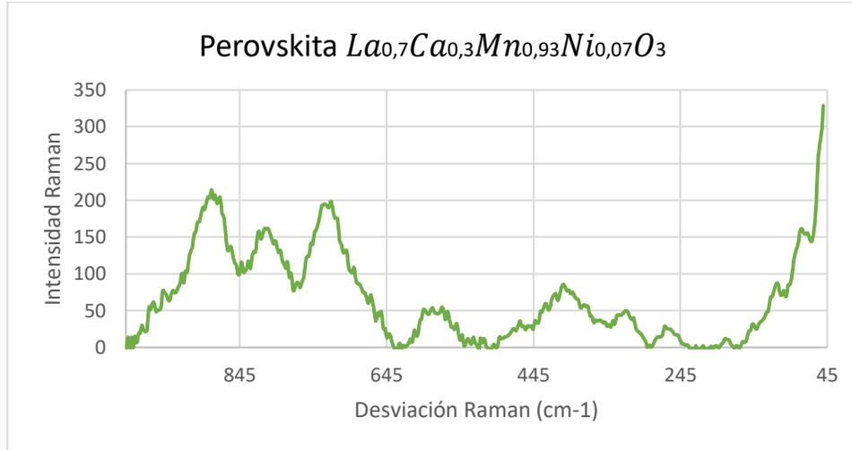
**Figura 19.** Espectro Raman perovskita  $La_{0,7}Ca_{0,3}Mn_{0,9}Ni_{0,1}O_3$
