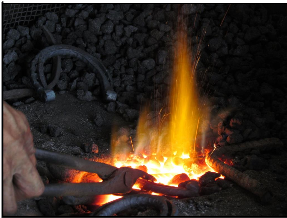
Imagen 5. Plano detalle del fogón.2020- Óscar Hurtado López. En esta imagen se evidencia un elemento fundamental en el oficio, el fuego; a partir de este, logran el calentamiento del carbón de piedra y la maleabilidad del hierro para así moldearlo
