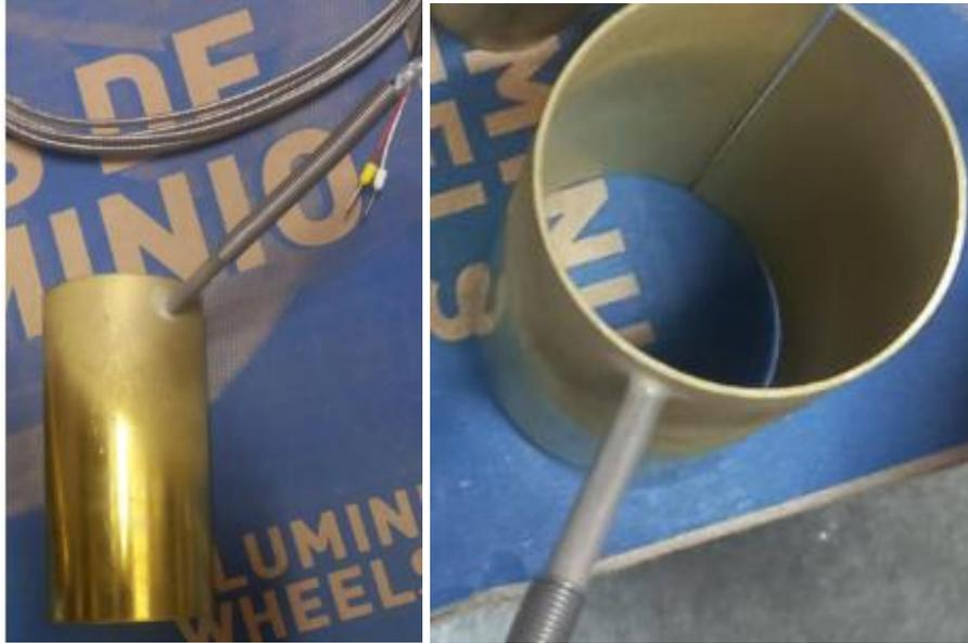
Figura 9. Modelo de termocupla tipo J original de las inyectoras Engel
