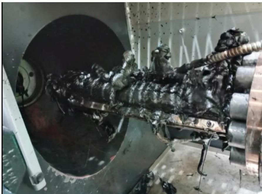
Figura 8. Empastamiento en la unidad de inyección.
