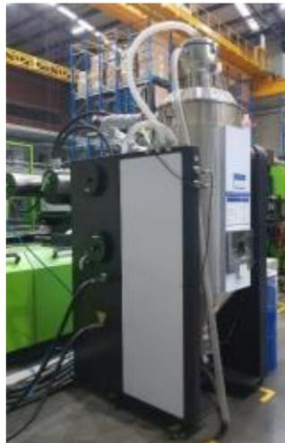
Figura 7. Deshumidificador para inyectoras
