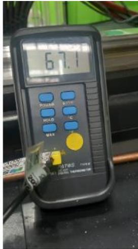
Figura 17. Temperatura censada con equipo patrón
