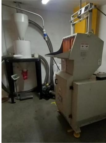
Figura 4. Molino granulador de la empresa SIP
