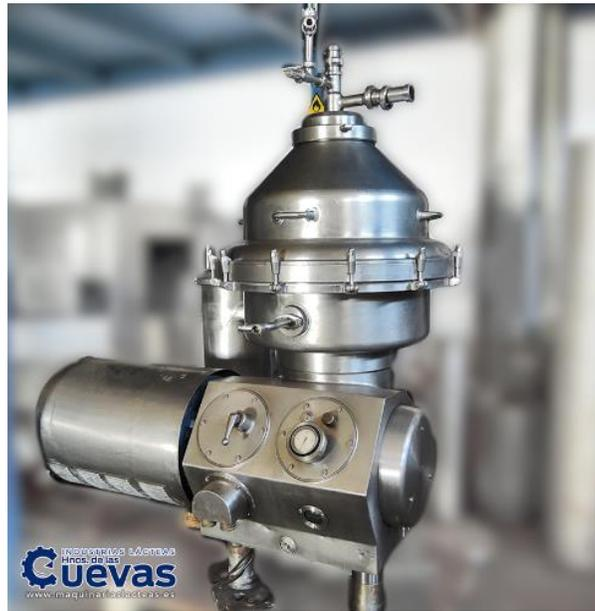
*Figura 1. Separadora centrífuga de la marca Alfa Laval.*
