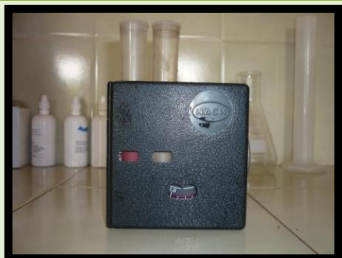
Foto 24. Medidor de cloro Fuente: Investigadoras
