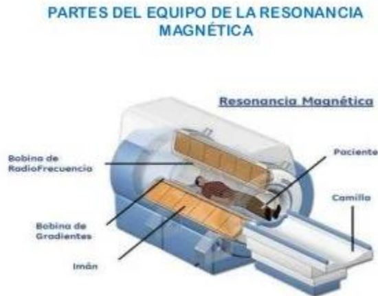
Fig. 4. Partes principales de un resonador magnético [25].
