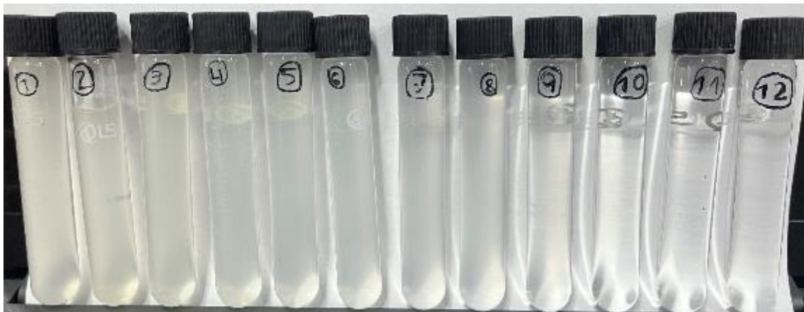
Anexo C.2. Muestras del baño de tintura obtenidas para la tela de referencia tipo A y tono habano cuando se llevó a cabo el seguimiento en la curva de tintura desde 50 °C hasta 105 °C cada 5 °C. (De izquierda a derecha)
