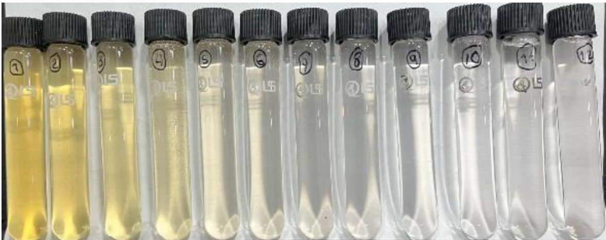
Anexo C.4. Muestras del baño de tintura extraídos cada 5 °C de la máquina tintorera cuando se procedía con la termorregulación incrementando la temperatura en el proceso de tintura para la tela de referencia tipo A en el tono habano (Desde los 50 hasta los 105 °C de izquierda a derecha)
