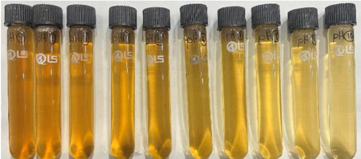
Anexo C.3. Muestras del baño de tintura extraídos cada 1 minuto de la máquina tintorera una vez se dosificó el dador en 10 minutos para la tela de referencia tipo A en el tono habano (Del minuto 1 al minuto 10 de izquierda a derecha)
