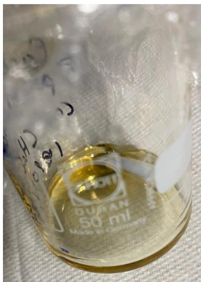
Debido al montaje utilizado (**Anexo 5**) el reactor utilizado no posee una salida para tomar muestras del producto, además de ser una reacción presurizada a 60 bar, por tanto, los análisis solo se realizaron al producto cuando la reacción termina. Con el catalizador de TBABr, se obtuvo una conversión casi total de los grupos carbonatos a 130 °C en 6 horas.
