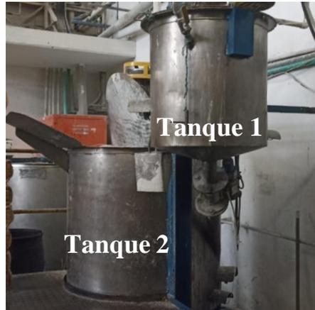
El tanque 1 (donde se hace el Carrier) tiene un pin metálico que funciona como el sensor de nivel y que en el PLC indica que hasta ahí son 98 Kg. Para conocer la capacidad real de este tanque se llenó manualmente hasta dicho pin de manera con ayuda de un recipiente que tiene una capacidad de 16,25 Kg. En total para alcanzar el nivel del PIN se necesitó añadir 8 veces el contenido de dicho recipiente lo cual equivale a 130 Kg en total.
