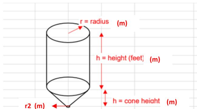
Para el tanque 2 se calcula el volumen del cilindro y del cono circular recto, la suma de estos dos será el volumen total del tanque (ecuaciones 3 – 5).
