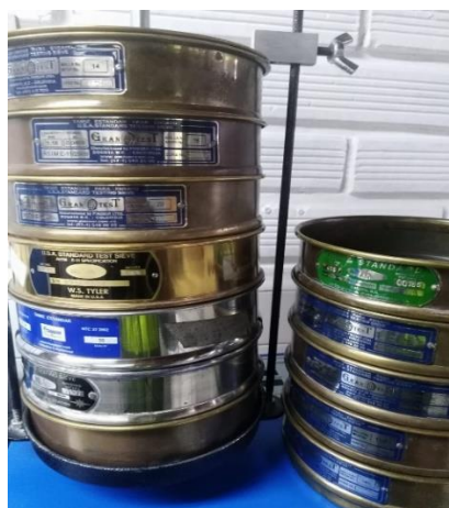
Figura 12. Serie de tamices utilizados en la caracterización granulométrica.
