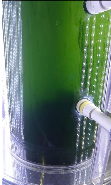
Figura 26. Detalle de biomasa acumulada en la parte baja del fotobiorreactor durante la experimentación. (Imagen de fuente del autor)
