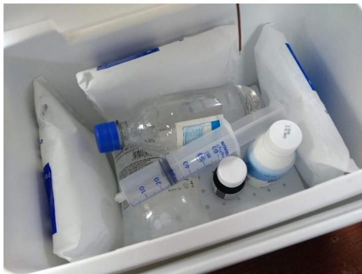
Fig. 23 Nevera de 10 L simulando una carga de medicamentos. Fuente propia.
