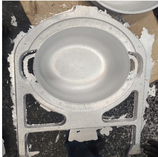
Fig. 2. Producto de fundición (a) skillet y (b) cuerpo caldero ovalado
