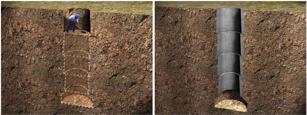
Figura 9 proceso de excavación y entibado de una pila manual.
