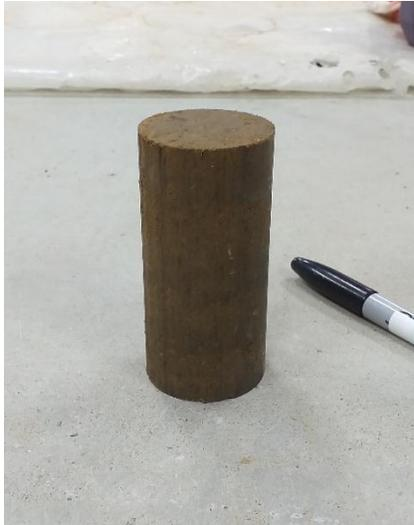
Figura 20: Fotografía probeta de suelo compactado para ensayo resistencia UCS.
