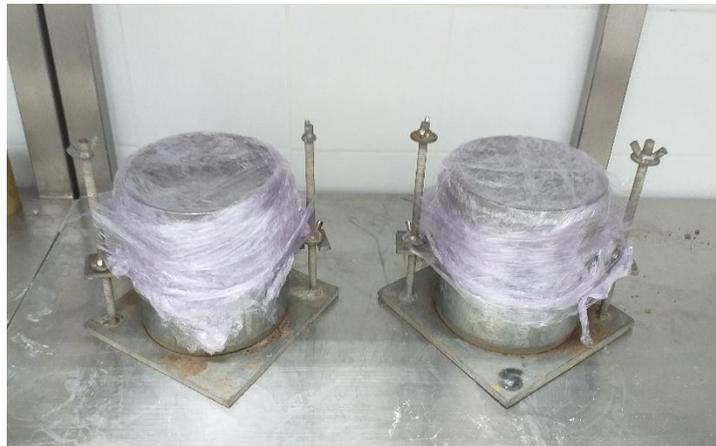
Figura 25: Curado de probetas de suelo estabilizado para CBR (28 días).
