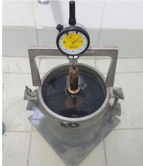
Figura 24: Ensayo de expansión de suelo estabilizado bajo inmersión.
