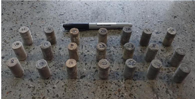
Figura 18: Fotografía probetas de cemento híbrido activado alcalinamente, CHAA.
