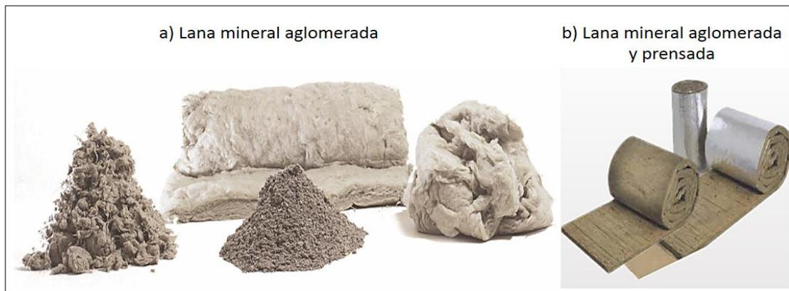
Figura 13: Imágenes de fibra de lana mineral comercialmente. Imagen modificada de (Calorcol, 2013)
