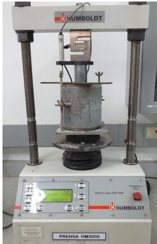
Figura 26: Ensayo de penetración CBR de suelo estabilizado.
