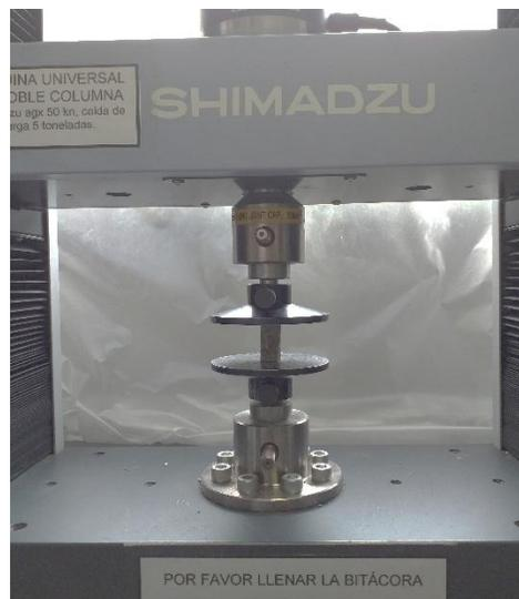
Figura 19: Fotografía ensayo de resistencia UCS, probeta de CHAA.
