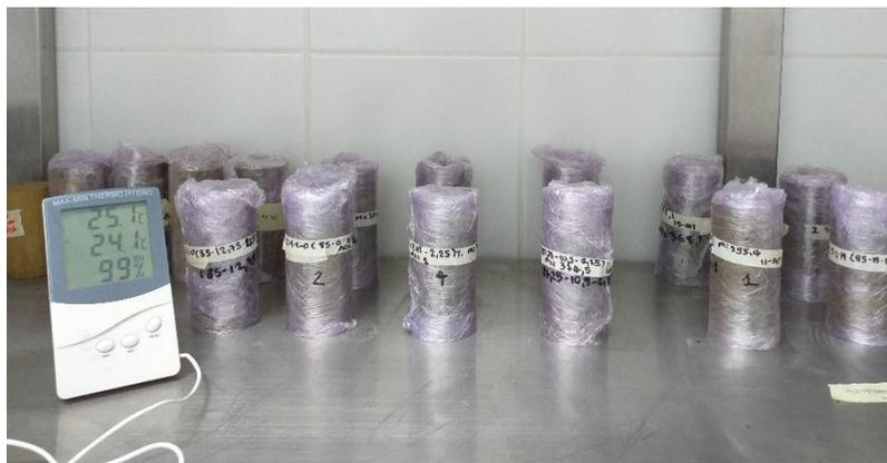
Figura 21: Fotografía probetas de suelo estabilizado en cámara húmeda (proceso de curado)
