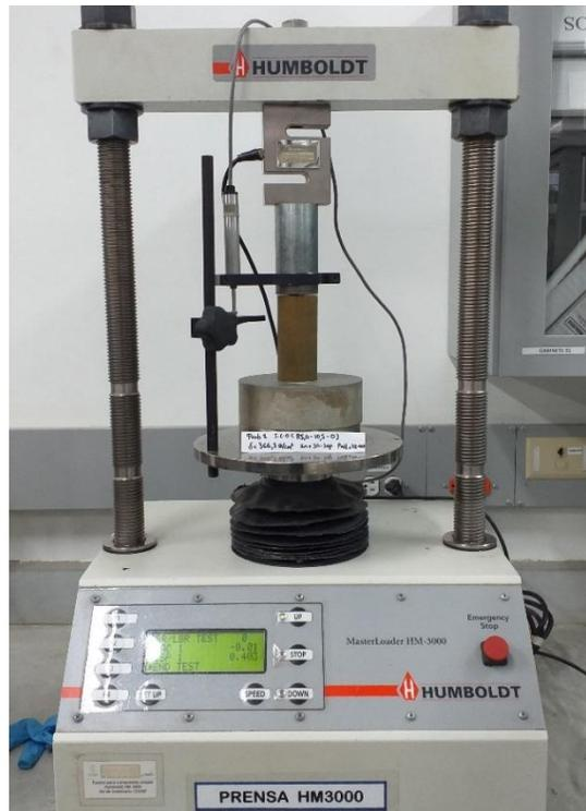
Figura 23: Ensayo de resistencia UCS de probetas de suelo.
