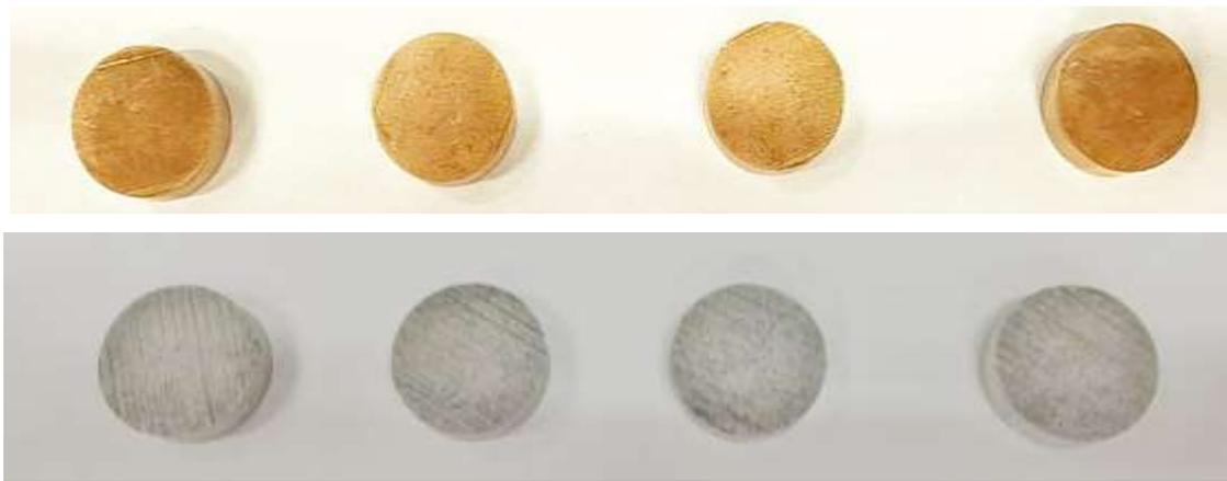
**Figura 39.** Muestras de bronce y acero inoxidable para los ensayos experimentales.
