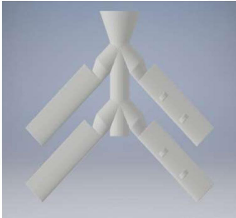
**Figura 30.** Diseño CAD del sistema de colada para álabes tipo Darrieus.
