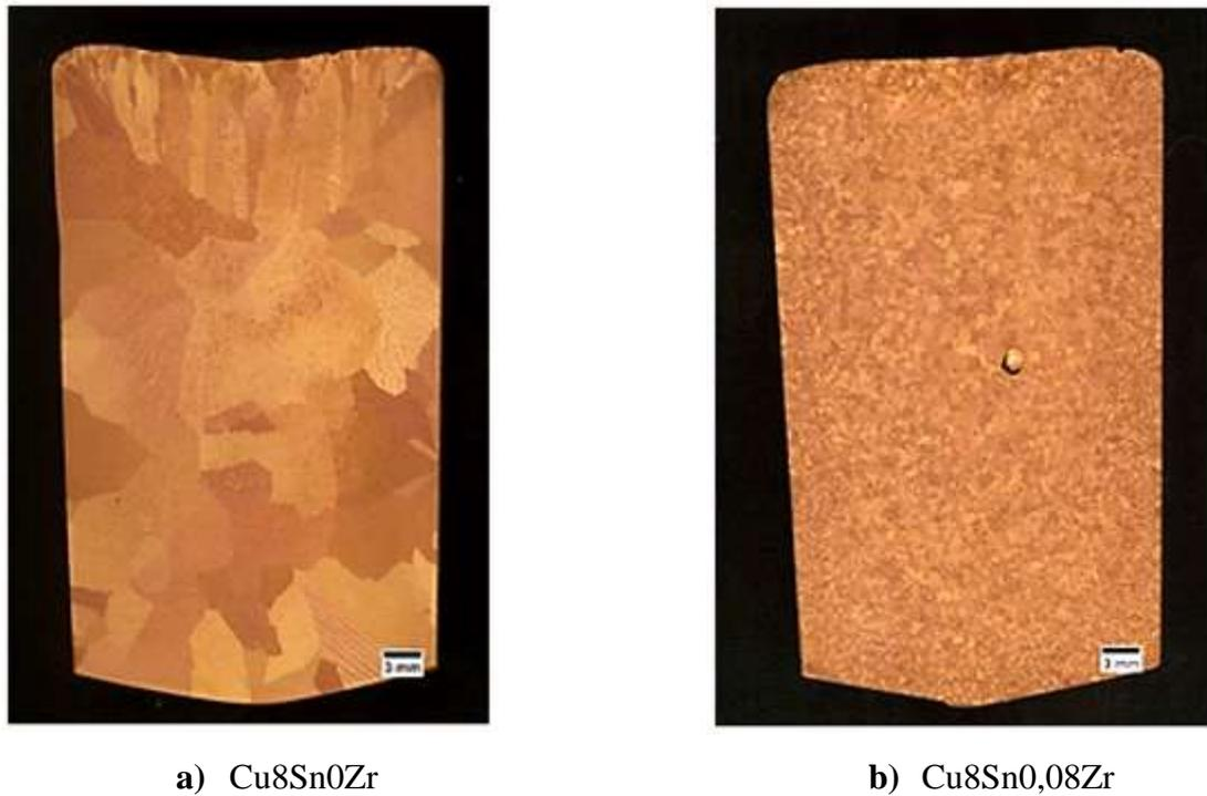
**Figura 19.** Macroestructura de la sección longitudinal de lingotes de la aleación Cu-8%Sn-0,25%P: a) sin adición de Zr, b) con adición de 0,08% de Zr [80].
