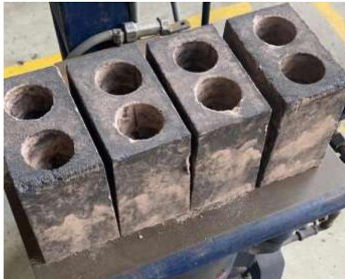
**Figura 38.** Molde de arena para fundición de cuerpos de prueba.
