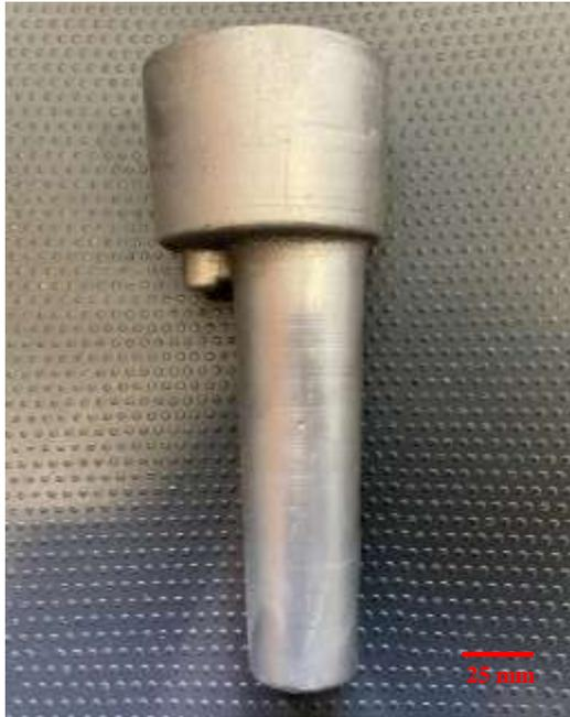
**Figura 35.** Prototipo del sistema de colada de barras.
