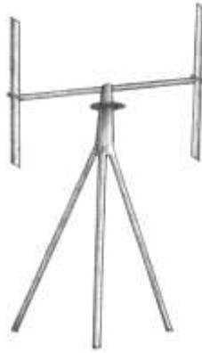
**Figura 3.** Rotor tipo H [28].
