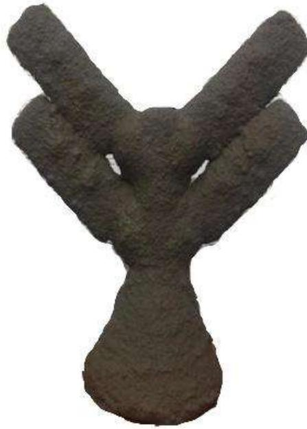
**Figura 36.** Molde cerámico para fundición de álabes.
