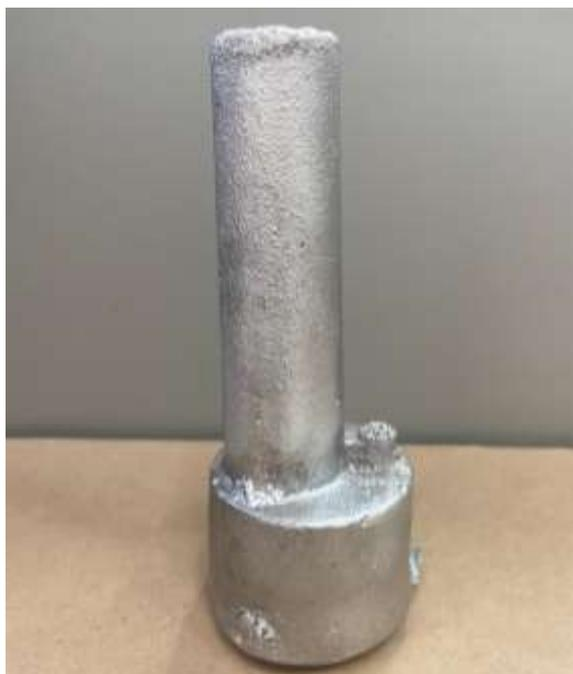
**Figura 49.** Barra fundida para obtención de cuerpos de prueba.
