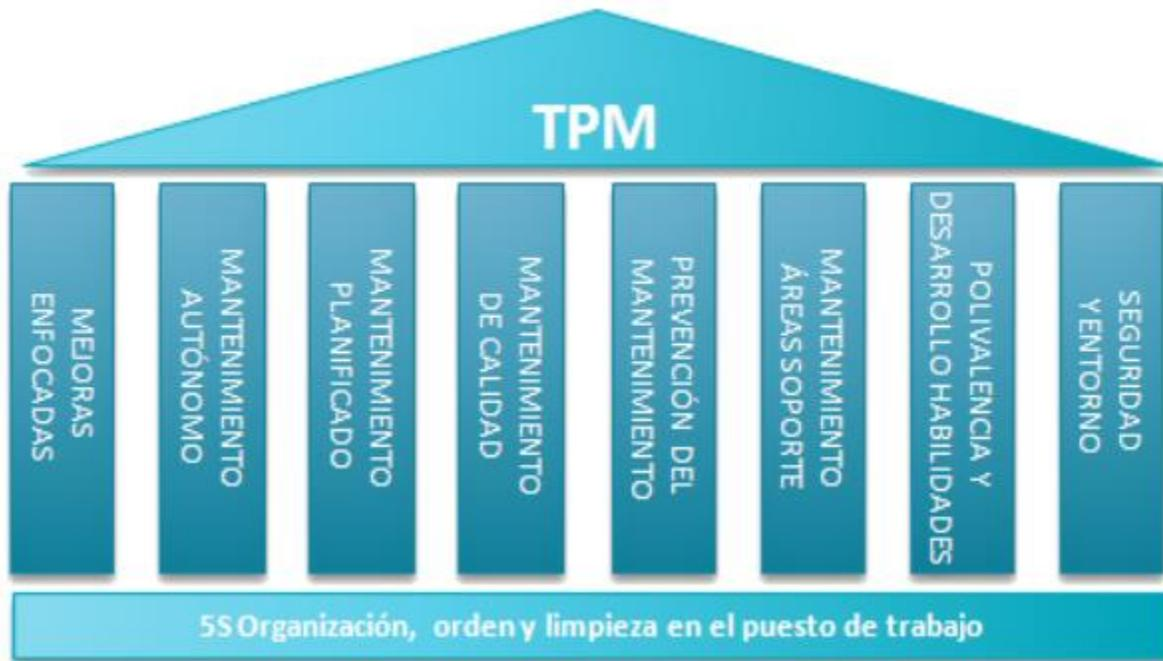
Fig. 13. Los 8 pilares y la base del TPM.
