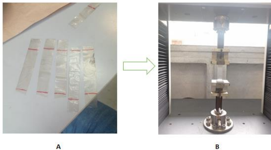
Fig 11. Montaje de pruebas mecánicas. A: Probetas de recubrimientos. B: Montaje en máquina Universal. Fuente: elaboración propia.
