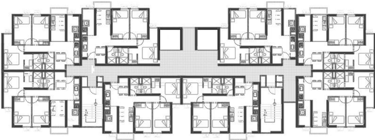
Figura 5 Distribución arquitectónica, planta típica. Fuente propia.
