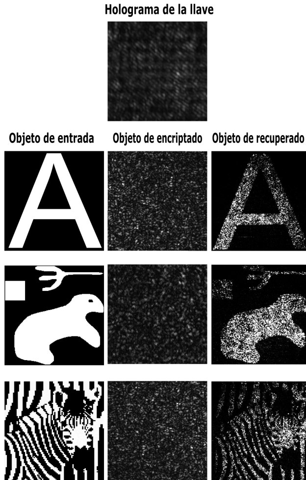
Figura 5.3: Resultados experimentales del proceso de encriptación y recuperación usando el sistema JFSC en línea y aplicando técnicas de reducción de ruido.
