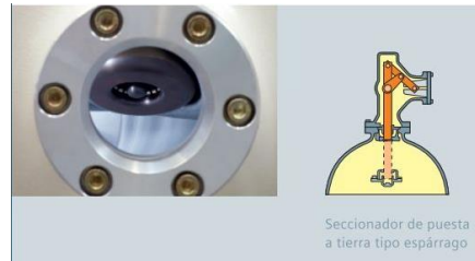
Figura 18. Seccionador de puesta a tierra [7].
