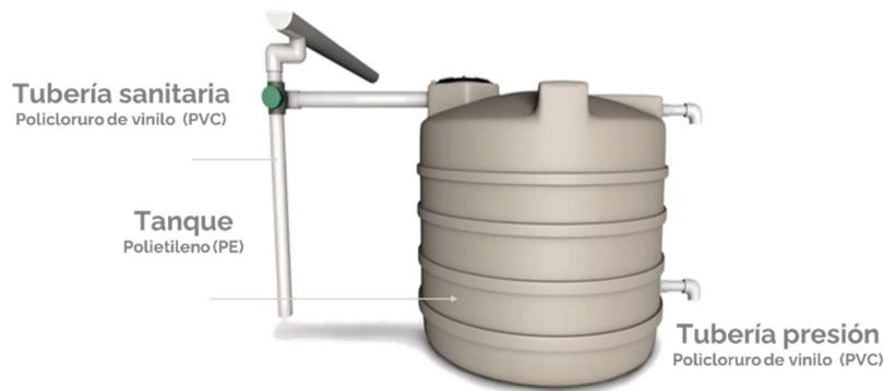
*Esquema 2. Sistema de captación de agua lluvia (Tomado de [www.rotoplas.com.mx](http://www.rotoplas.com.mx))*
