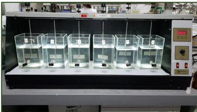
Figura 11. Test de jarras empleado en ensayos de coagulación Fuente: Elaboración propia
