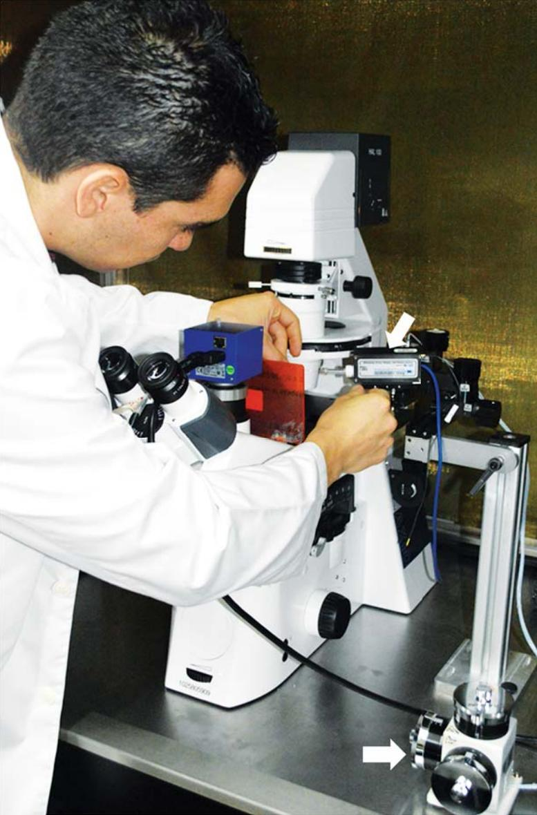
Microscopio de fluorescencia con un micromanipulador (flecha horizontal) que permite mover las pipetas distancias muy pequeñas (centésimas de milímetro). También se ve el preamplificador (flecha diagonal) que permite multiplicar la señal registrada para que pueda ser leída por los equipos y ser luego mostrada en el computador.
