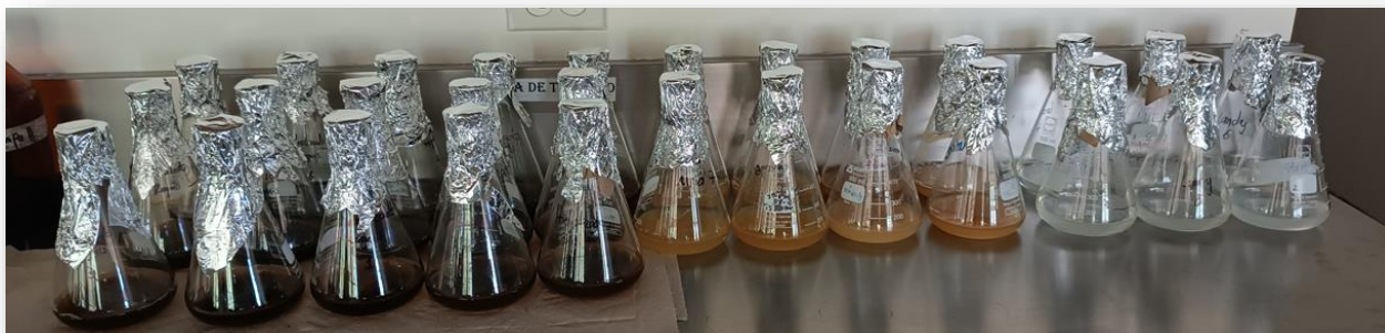
Fig. 13 Fermentación de los 4 medios de cultivo a las temperaturas 15 - 32 - 37 y 40 °C 36 horas de reacción.
