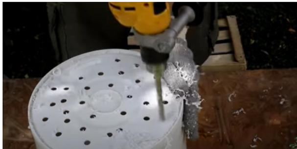
Una vez terminada la serie de agujeros en el primer balde, se repite el procedimiento con otro de los tres baldes. Ahora vamos a hacer los agujeros de los costados del balde, los cuales tienen como propósito soporte y separación entre balde y balde, para esta parte tomamos la regla y el marcador, señalamos una medida de aproximadamente 7 cm desde la base hasta la parte superior
