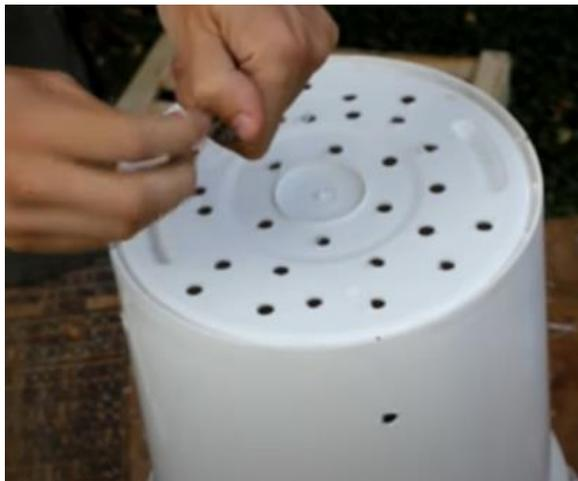
Luego de tener los agujeros laterales procedemos a ensamblar un tornillo y una arandela y con la tuerca aseguramos el ensamble
