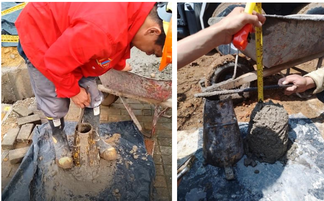
Figura 5 Prueba de asentamiento
