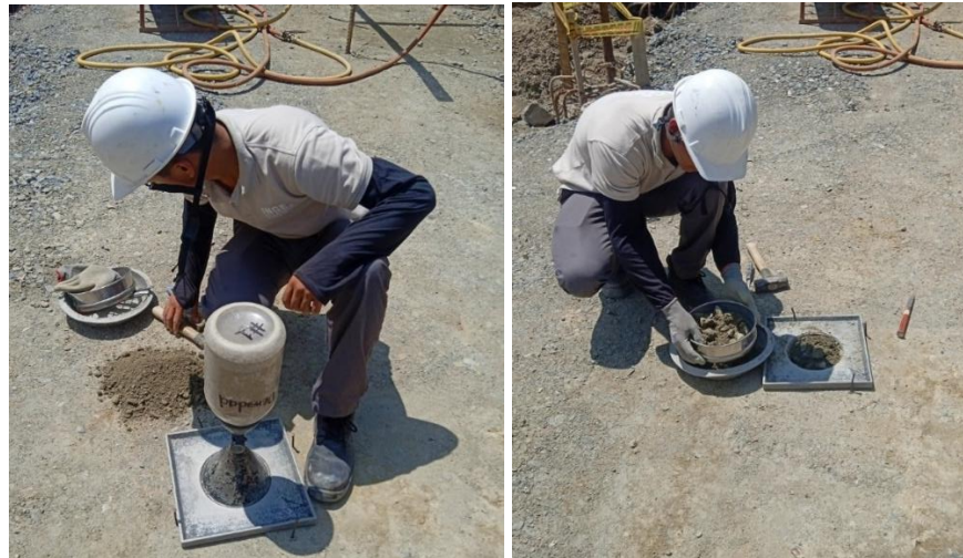
Figura 6 Ensayo de densidad
