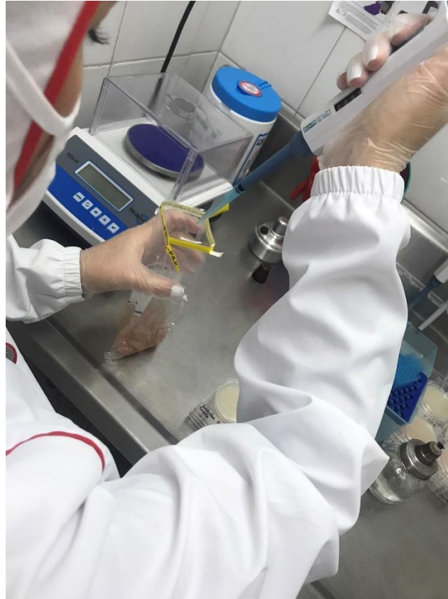
Fig.19. Siembra de 1000 \mu L de medio en placas Compact Dry.
