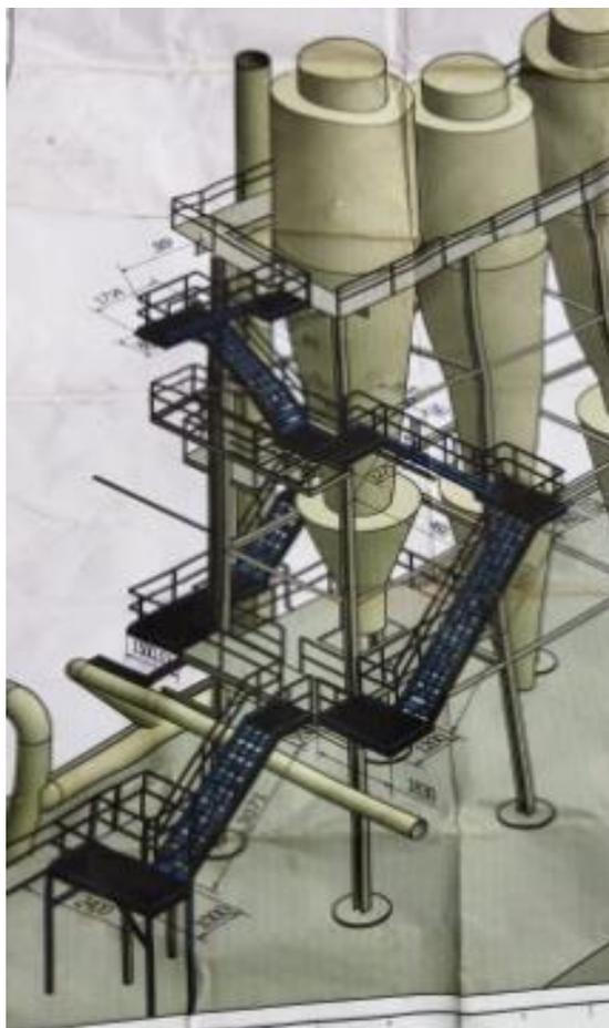
*Figura 19, Plataformas y escaleras para acceso a ciclones (Modelo).*
