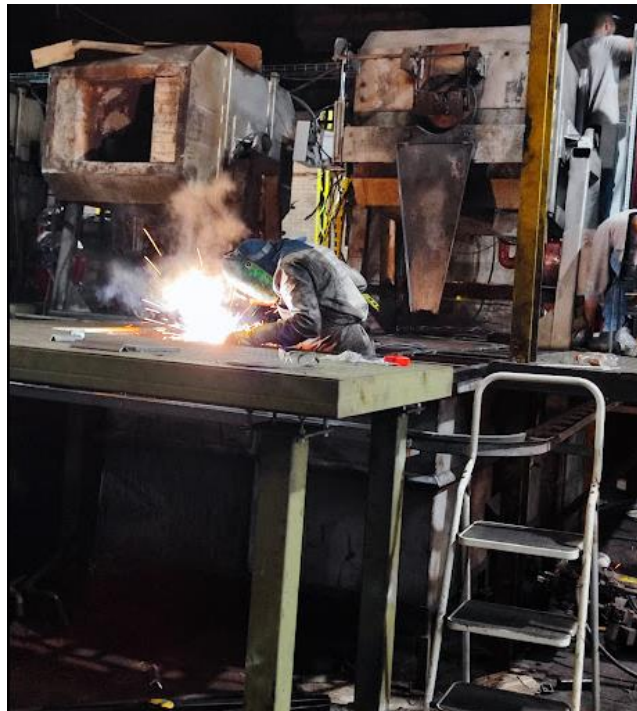
Figura 19. Fabricación de módulo de tanques de la plataforma.
