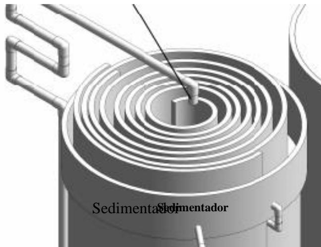
*Figura 10. Sedimentador.*
