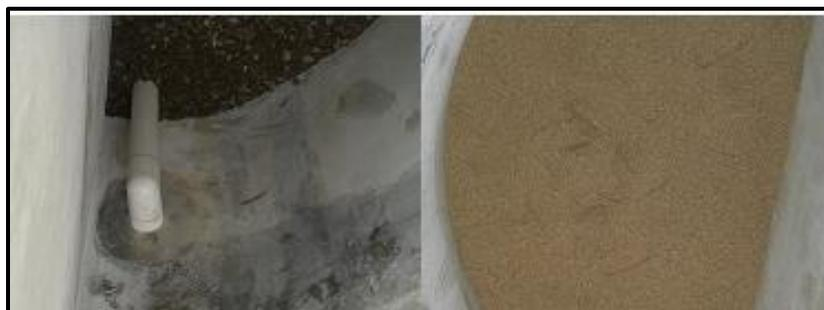
*Figura 11. Grava de soporte del lecho y arena de filtración.*
