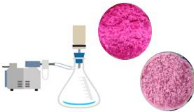
Figura 19. Filtración al vacío para purificación
