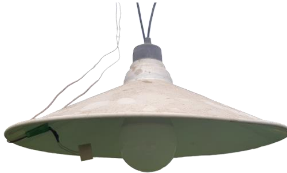
Figura 9. Montaje de fotoresistor en bombillo de cada guirnalda.
