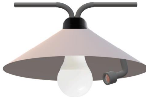
Figura 3. Montaje de LDR en el bombillo de una guirnalda.
