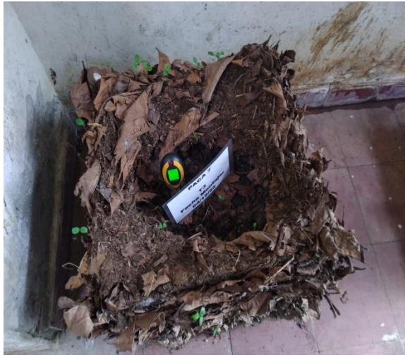
Fig. 47 Hundimiento en paca biodigestora T3
