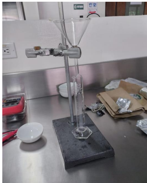
Fig. 26 Montaje para llevar a cabo la densidad real
