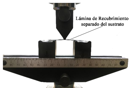
Figura 6-26. Montaje para el ensayo de flexión en tres puntos para los recubrimientos.
