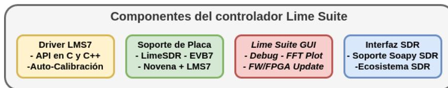
Figura 2-9: Conjunto de software y controladores del **Lime Suite**. Modificado de [8]
