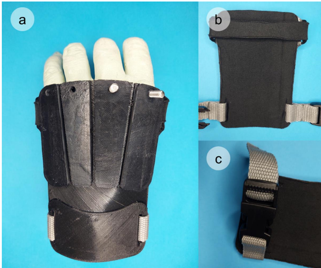
Figura 57. Prototipo del soporte flexible para adaptación de cuatro dedos. a) Vista superior del soporte. b) Vista posterior del soporte. c) Sujeción del soporte a la muñeca con chapetas.
