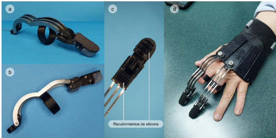
Figura 50. Octava iteración. a) Octavo prototipo. b) Vista lateral de prototipo. c) Recubrimiento de silicona de la falange media y distal. d) Pruebas de uso con el octavo prototipo del dispositivo.
