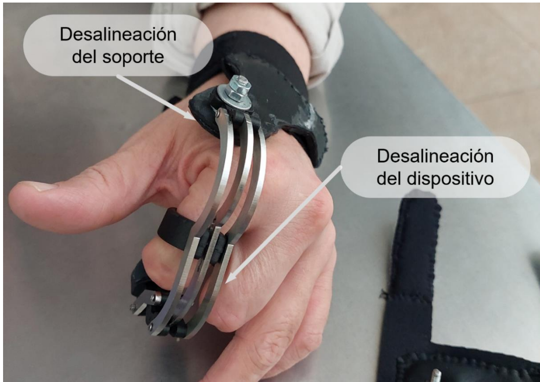
Figura 54. Desalineación del soporte del dispositivo debido al pivote en la sujeción de la muñeca.
