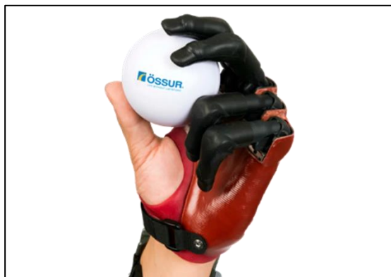
Figura 10. Prótesis mioeléctrica i-Digit Quantum de la empresa Össur [25].
