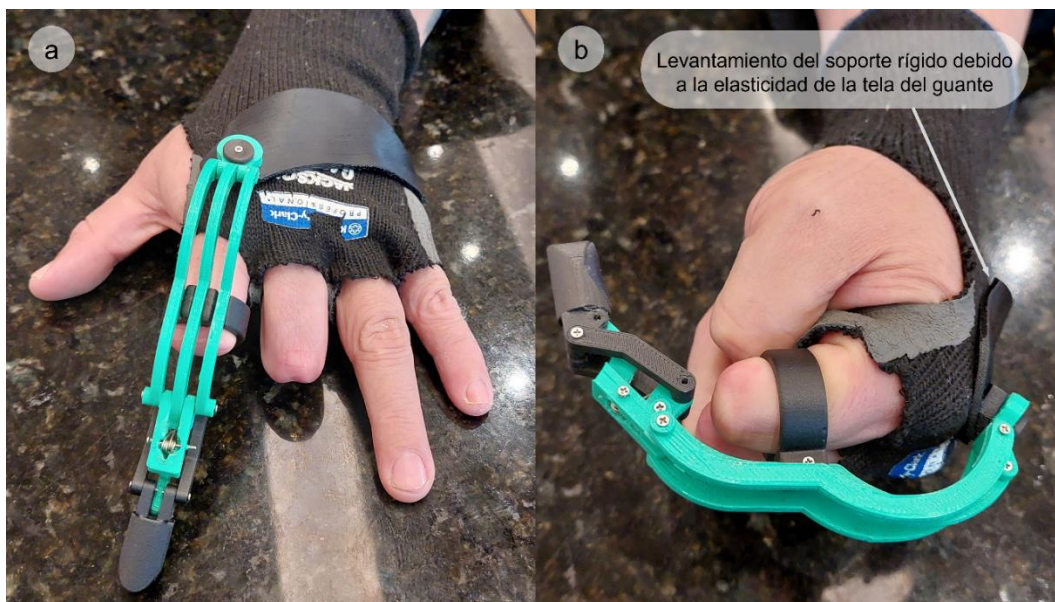
Figura 52. Propuesta de soporte. a) Adaptación a un guante modificado. b) Levantamiento de la pieza rígida durante flexión.
