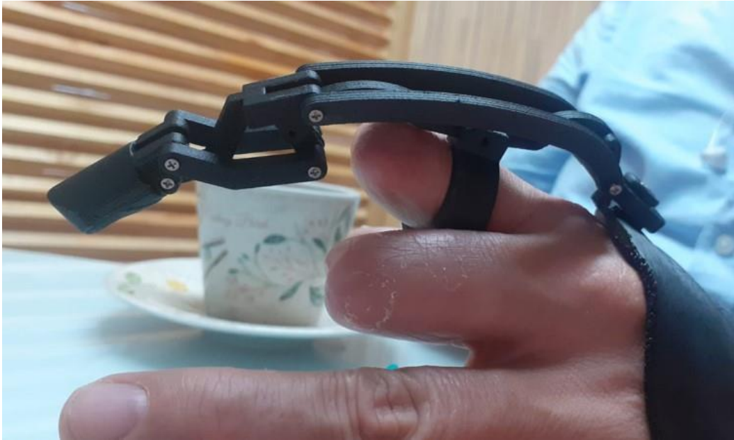
Figura 46. Extensión incompleta del quinto prototipo.
