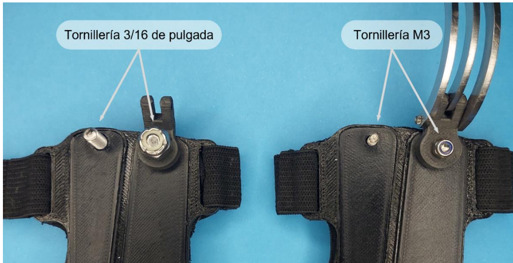
Figura 59. Comparación entre los elementos mecánicos de unión del dispositivo al soporte de dorso.
