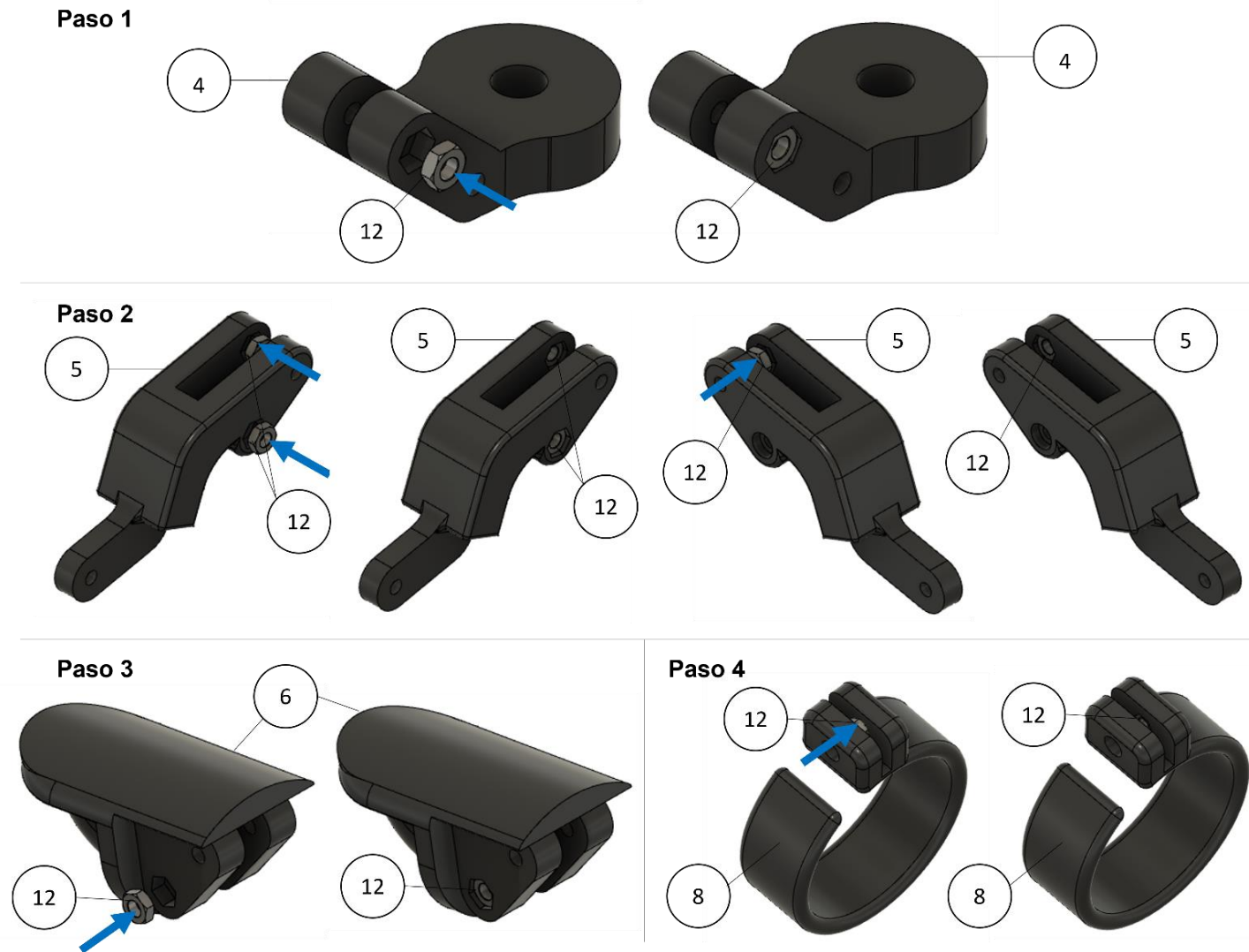
Figura 68. Montaje de las tuercas en los componentes plásticos.
