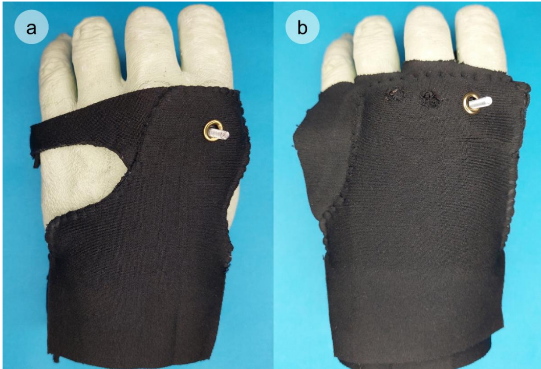
Figura 55. Prototipo del soporte en tela con bolsillo y doble sujeción. a) Primera iteración adaptada a un solo dedo. b) Segunda iteración adaptada a dos dedos.
