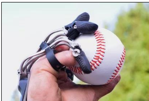
Figura 11. Prótesis accionada por el cuerpo. MCPDriver de la empresa Naked Prosthetics [26].
