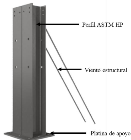
Figura 97. Estructura principal estación motriz.
