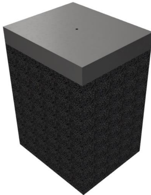
Figura 122. Bloque de concreto del sistema de tensión.
