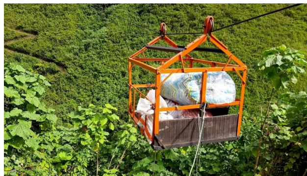
Figura 10. STC bicable tipo garrucha.
