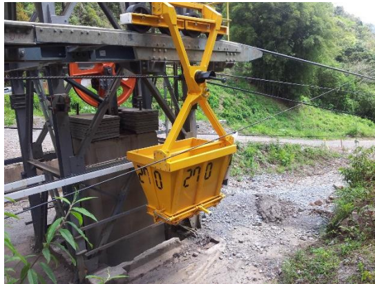
Figura 5. Tolva para el transporte de material minero.
