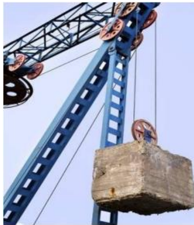
Figura 22. Sistema de tensión con contrapeso de concreto [32].
