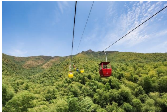
Figura 8. STC monocable unidireccional para personas.
