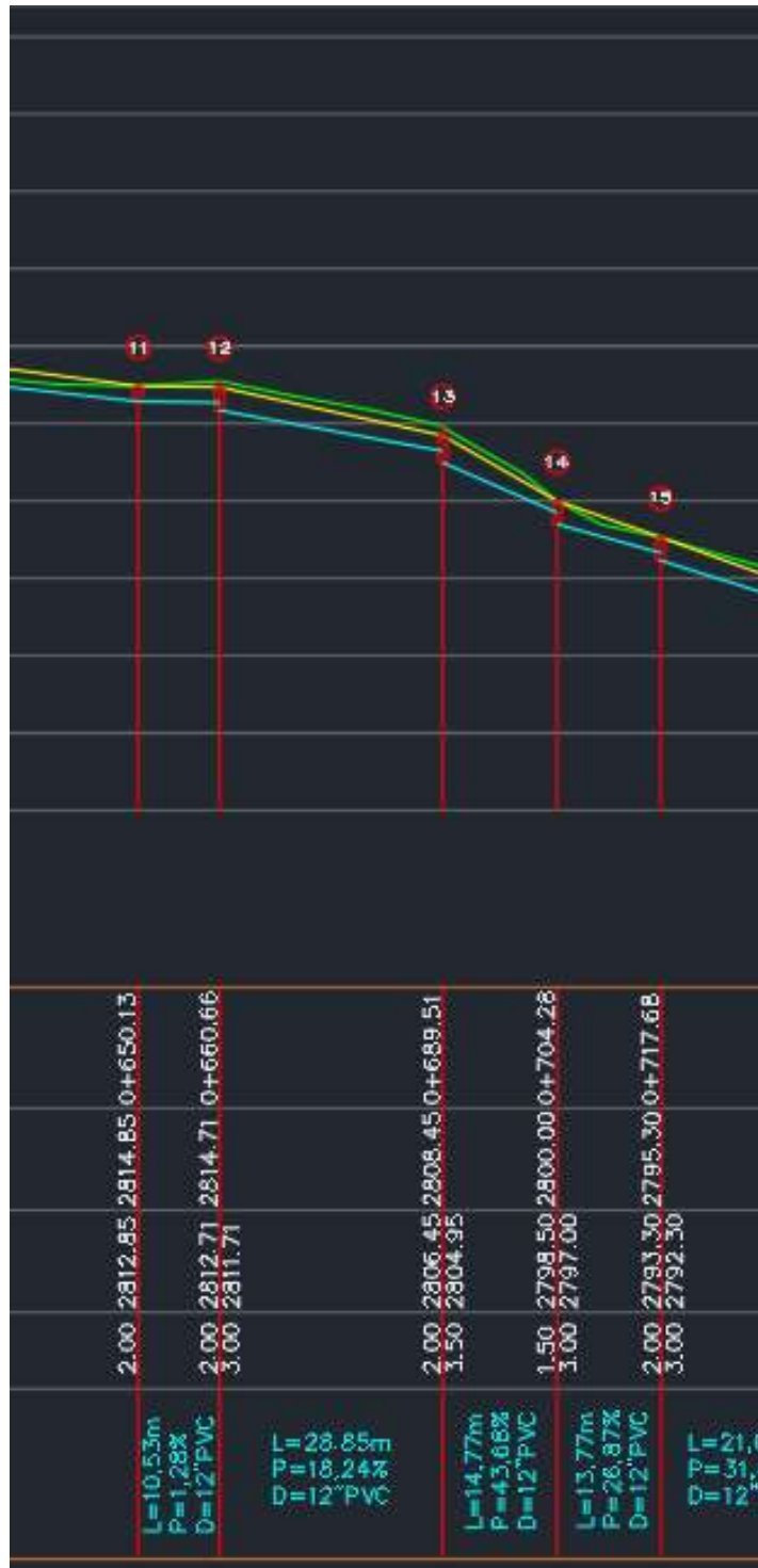
Ilustración 3: Perfil y detalles alcantarillado tramos 11, 12, 13, 14 y 15.
