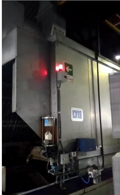
En el horno se hacen pasar las láminas por medio de un sistema de cadenas con el fin de secar el barniz previamente aplicado, para esto cuenta con cuatro quemadores distribuidos a lo largo del horno, esta línea es muy importante ya que solo se cuenta con un horno barnizador en la empresa.
