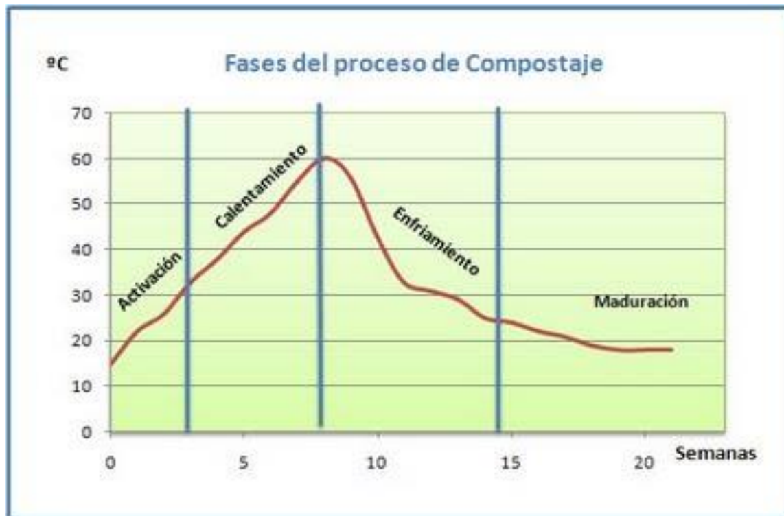
Figura 1 Comportamiento de la temperatura en las fases del proceso de compostaje.
