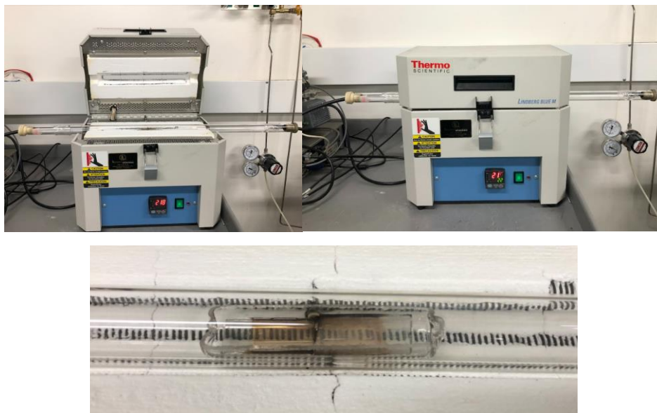
Fig. 10. Imágenes del horno tubular y muestras de fotoelectrodos fabricados por espray pirólisis en portamuestras de cuarzo.
