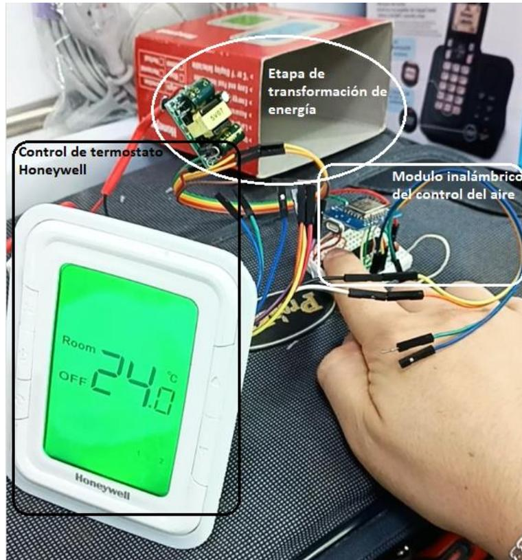
Fig. 18. Prueba parcial semiautomatizada del módulo de control del aire.
