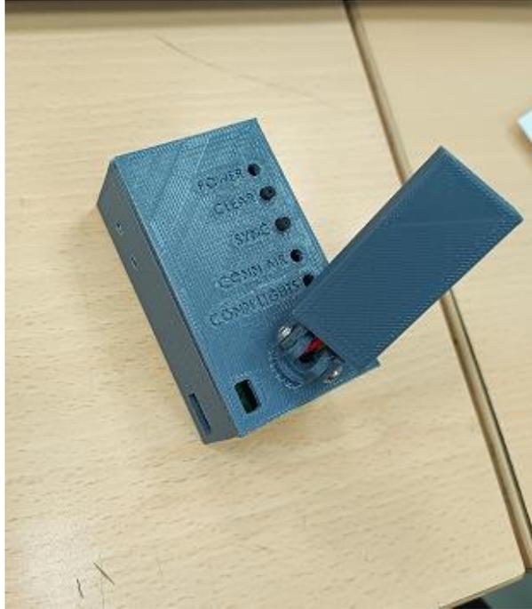
Fig. 12. Módulo sensorial con cubierta final impresa en 3D.
