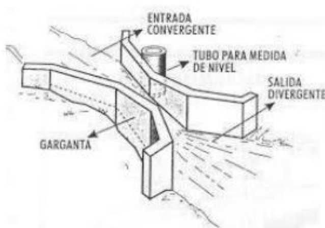
Figura 3. Canaleta Parshall. Fuente: Aspectos básicos de pretratamiento operación y mantenimiento.
