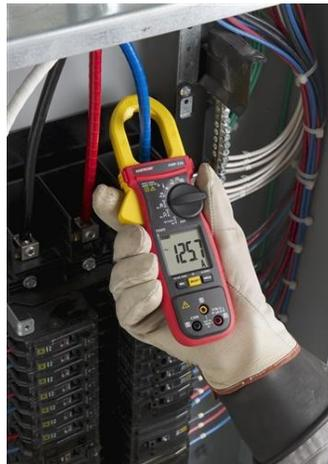
*Figura 28: Método de captación de amperaje sin interrumpir la línea con gancho tomada de Google.*
