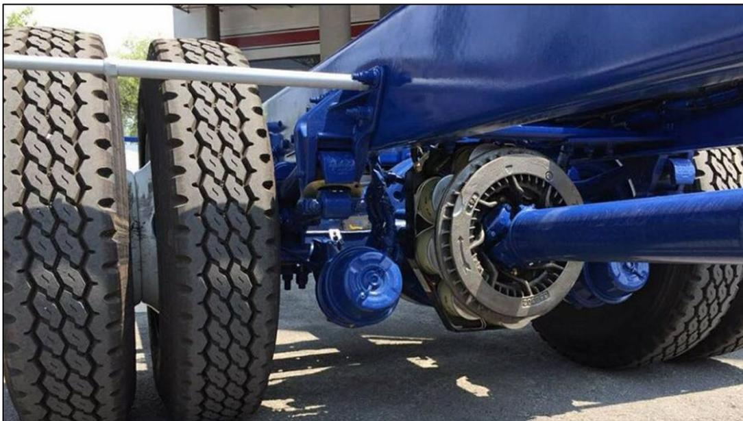
**Figura 7:** Montaje de retardador electromagnético en flecha cardánica tomado de:
