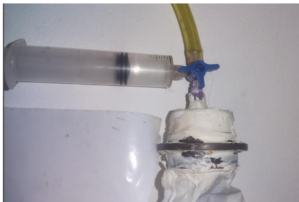
Fig. 8 Método de contabilización del biogás producido y almacenado en bolsa hermética, usando jeringa de 20 mL conectada a la llave de paso.
