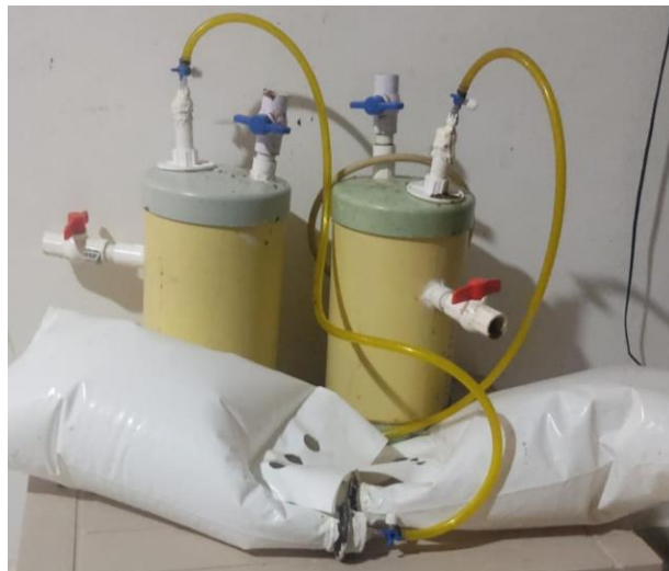
Fig. 25 Bolsas de almacenamiento de biogás llenas.
