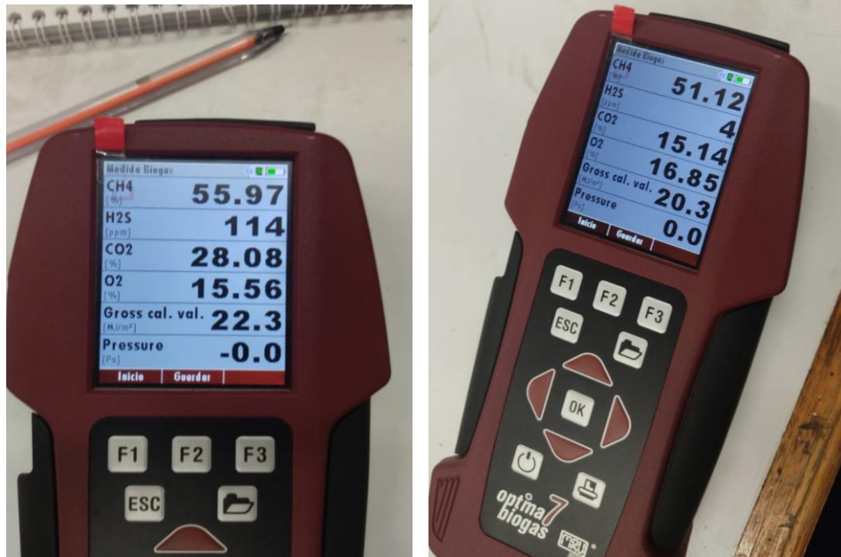
Fig. 26 Medición de la composición del biogás obtenido para CVC y EMC.
