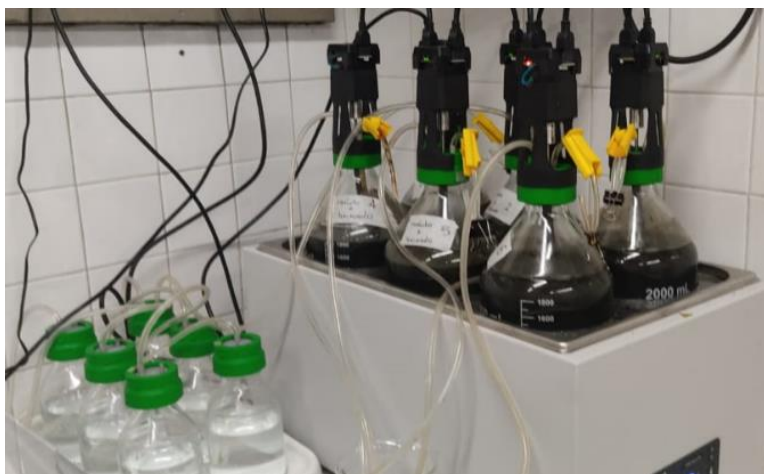
Fig. 5 Sistema AMPTS II – Light en evaluación de potencial bioquímico de metano para la CVC, el EMC y una codigestión de ambos.
