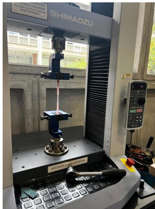
Fig. 13. Montaje típico para un ensayo de tensión en la máquina universal.
