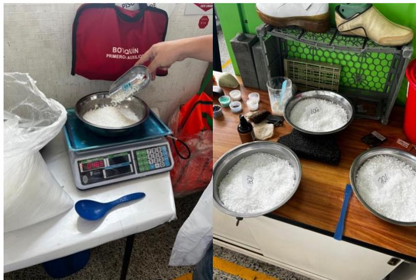
Fig. 23. Preparación de la carga de cada una de las formulaciones de PP para inyectar.
