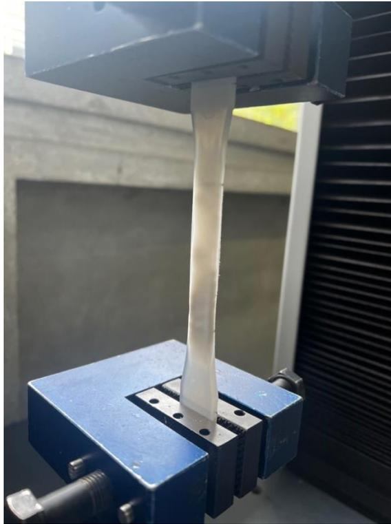
Fig. 29. Montaje de la máquina universal con probeta de prueba.
