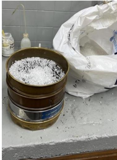
Fig. 21. Proceso de tamizado del PPR.
