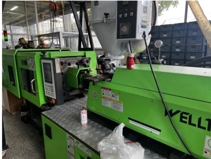
Fig. 22. Inyectora Welltec TTI-90SEII.
