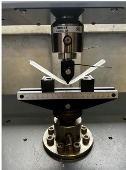
Fig. 10. Montaje de flexión con tres puntos de apoyo.
