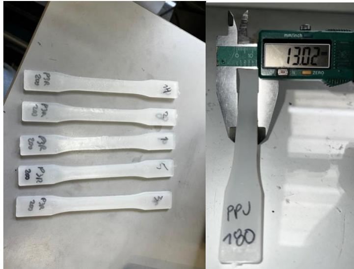
Fig. 26. Probetas para flexión. Medición de ancho y espesor.
