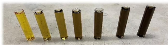
Figura 4 Curva de calibración del método yodo/almidón para las pruebas de hidrólisis.
