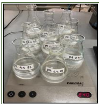
Figura 6 Montaje experimental para las pruebas del efecto del pH en la hidrólisis.
