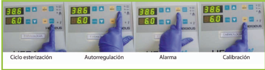
Figura 1.7. Funciones básicas para la graduación de la incubadora de CO 2 .
