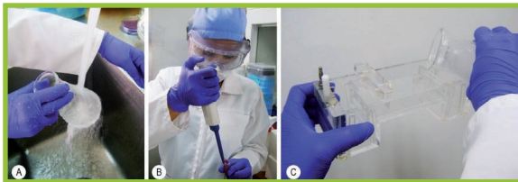
Figura 6.10 A. Reducción de vapores; B. Adición de bromuro de etidio; C. Adición de la mezcla en la cama de electroforesis.
