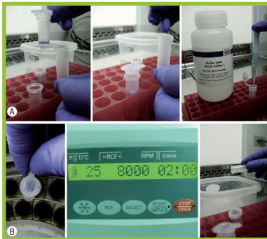
Figura 6.5. A. Transferencia de columna a tubo de colección; B. Número de revoluciones por minuto (RPM) en centrifuga y descarte de tubo de colección.
