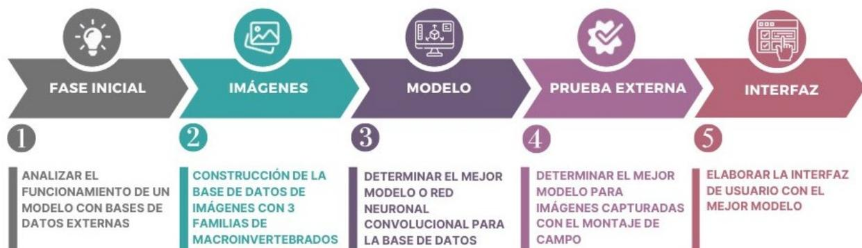
En la fase inicial se entrena el modelo AlexNet con imágenes de una base de datos libre, con el fin de definir parámetros para la captura de imágenes mediante estereomicroscopio, factores importantes en la generación de la base de datos y parámetros de entrenamiento.
